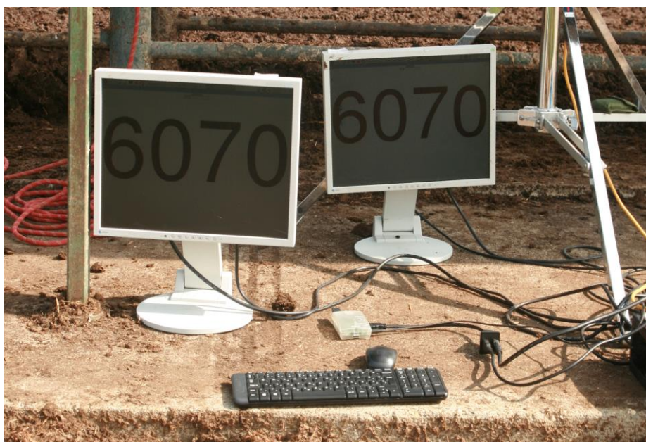
4. kép: Fül számazonosító monitorok Hortobágyon, az RPi kártyaszámítógéppel, vezeték nélküli billentyűzet és egér, és a HDMI elosztóval.
